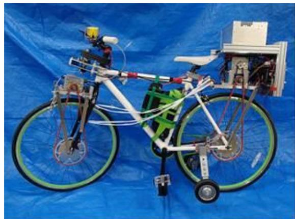
図1. 前後輪独立駆動電動アシスト自転車
