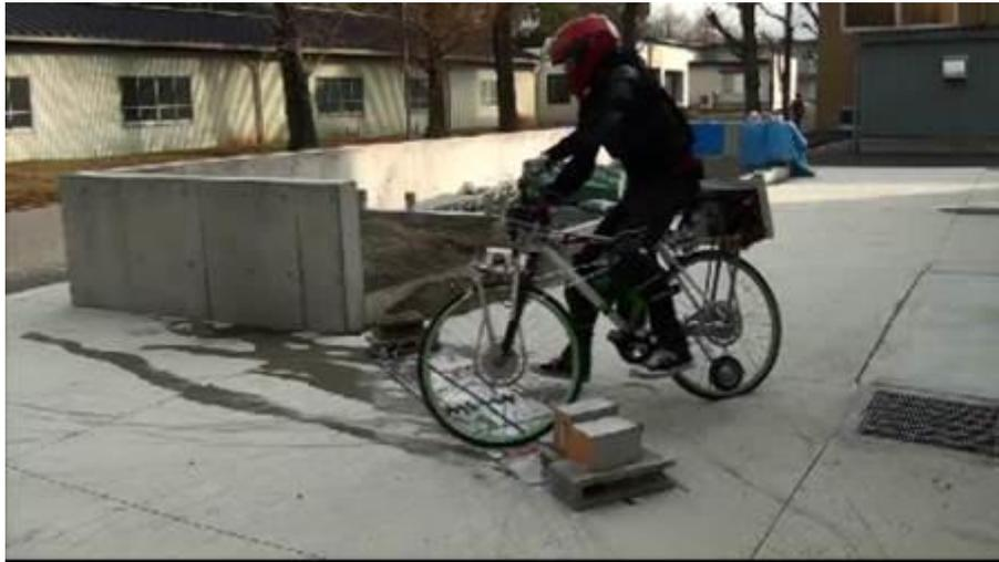
図3. 低摩擦路における旋回実験
